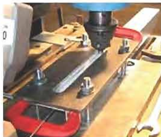
Acoperire prin FSW cu aliaj de aluminiu pe oțel
