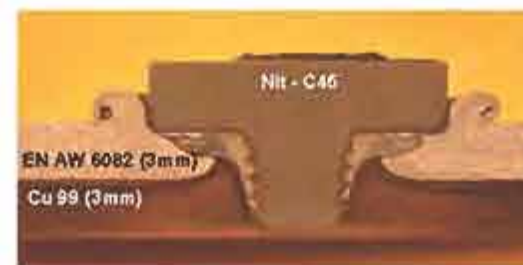
Imbinare prin nituire cu efect hibrid (prindere mecanica - sudare prin frecare)
