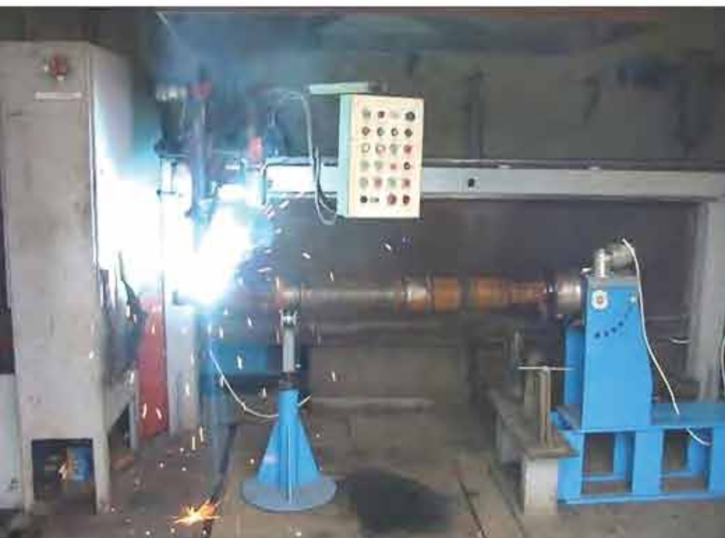
Recondiționare piese uzate cu procedeul MIG/MAG automatizat
