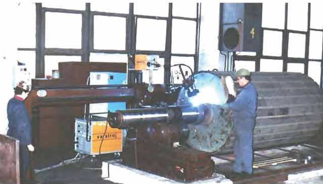
Mecanizare proces de încărcare prin sudare MIG/MAG (oțel C45)
