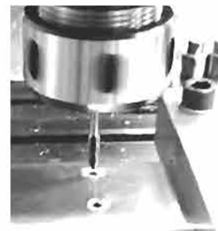
Filetare automată prin formare, fără așchiere
