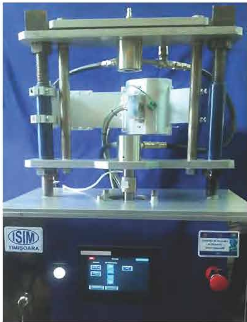
Instalație de încercare la oboseală termică a depunerilor din materiale avansate, ILOT-3
